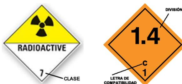
**La altura de los caracteres no debe ser inferior a 25 mm.** Cuando las dimensiones no estén especificadas, todos los elementos deben respetar aproximadamente las proporciones representadas. (En los camiones se suele utilizar el formato de 300 x 300 mm).
