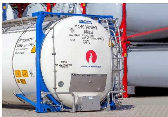
“**Cisterna**”: un depósito, incluidos sus equipos de servicio y de estructura. Cuando la palabra se utiliza sola, engloba:
