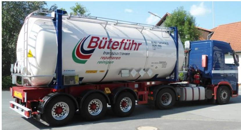
**“Cisterna fija”**, una cisterna de una capacidad superior a 1000 litros que está fijada sobre un vehículo (que se convierte así en un vehículo cisterna) o que forma parte integrante del chasis de tal vehículo;
