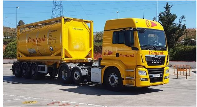
**“Contenedor de gas con elementos múltiples (CGEM)”**, un elemento de transporte que comprende elementos que están conectados entre ellos por una tubería colectora y montados en un cuadro.
