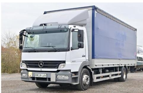
**9.3.3 Vehículos EX/II** Los vehículos se deberán diseñar, construir y equipar de modo que las materias y los objetos explosivos queden protegidos de riesgos exteriores y de la intemperie. Deberán ir cubiertos o entoldados. El toldo deberá ser resistente al desgarramiento y estar formado por un material impermeable y difícilmente inflamable. Deberá ir bien tenso, de manera que cierre el vehículo por todos los lados. Todas las aberturas en el compartimento de
