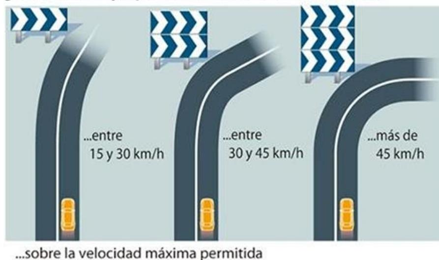
Las señales de balizamiento pueden ser dispositivos de guía. Entre estos dispositivos se encuentran los paneles direccionales permanentes, mediante los cuales se señala el sentido de la circulación ante la aparición de un peligro puntual.
