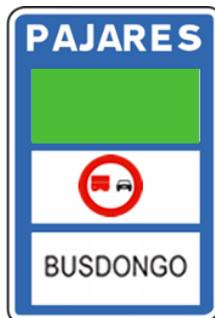
Señal con paneles 1, 2 y 3 informando de las condiciones de transitabilidad.
